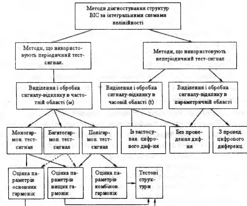
Рис. 1. Класифікація методів електрофізичного діагностування структур ВІС за інтегральними ефектами нелінійності
