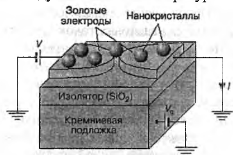
Рис. 26. Схематичне зображення одноелектронного транзистора з нанокристалом CdSe як активним елементом
